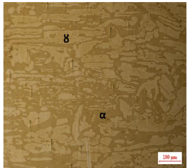
Figure1 : identification des phases ferritique et austénitiques de l'acier inoxydable référence 2101 avec grossissement X50 et X500
